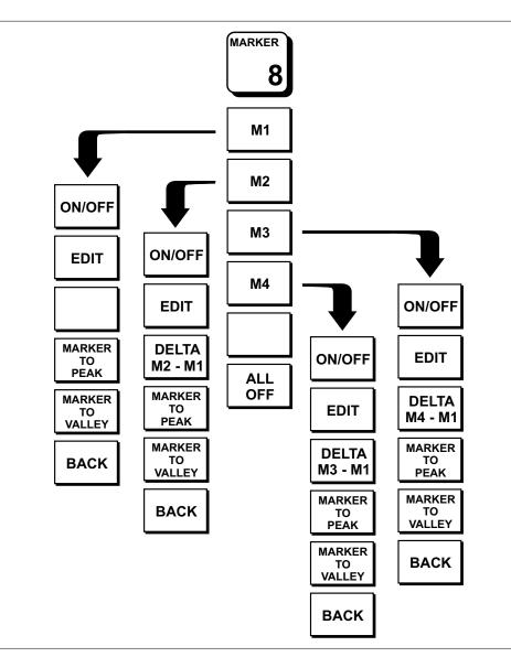
Figure 3-6. Marker Key Soft Key Labels
